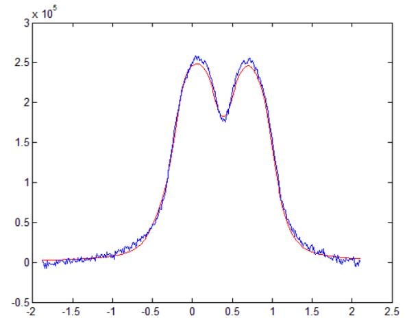
Результат измерения (синий цвет) и модель измеренного спектра при условии, что входной спектр заменен на оценку минимальной возможности потерь (красный цвет)
