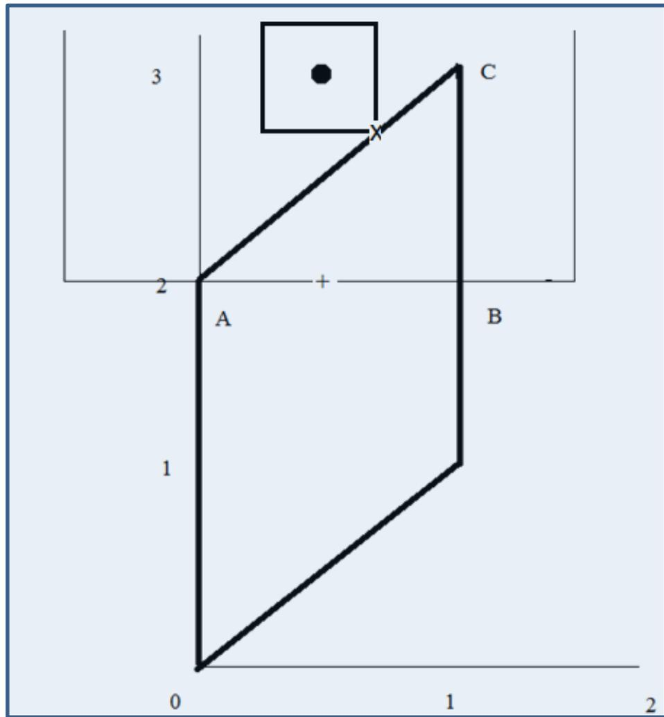
$$s_{ms} = \begin{pmatrix} 0.5 \\ 3 \end{pmatrix} = \begin{pmatrix} 1 & 0 \\ 1 & 2 \end{pmatrix} \begin{pmatrix} g_1 \\ g_2 \end{pmatrix} + \begin{pmatrix} v_1 \\ v_2 \end{pmatrix}, |v_i| \leq 1, \quad 0 \leq g_i \leq 1.$$
