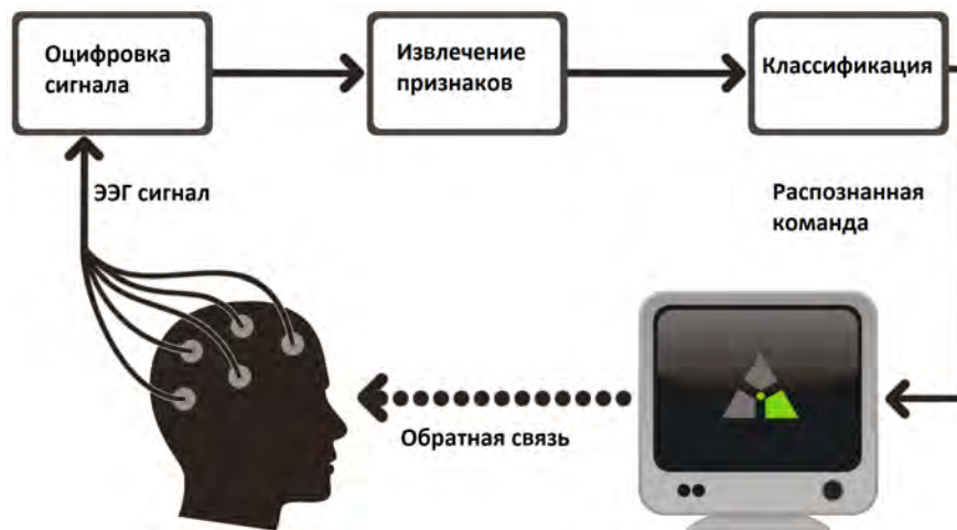
Рис. 1. Упрощенная схема нейрокомпьютерного интерфейса.
