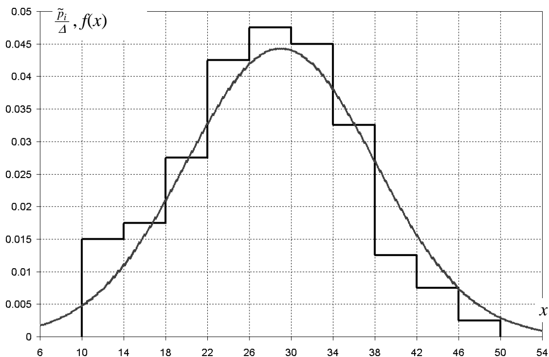
Рис.2. Гистограмма для выборки из нормального распределения с параметрами m = 29 ; \sigma = 9 и плотность вероятности.
