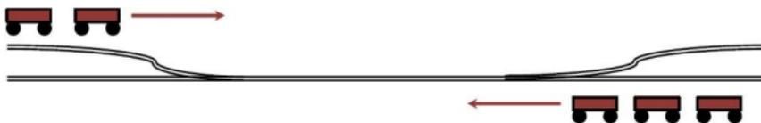
Дано:  $n_1$  поездов в одном направлении,  $n_2$  поездов в другом направлении, время движения по однопутному участку  $p$ , интервал безопасности  $\beta$ , известно исходное расписание движения поездов без закрытия участка дороги:  $r_s^i$  — момент доступности поезда  $i$  в направлении  $s$ .
