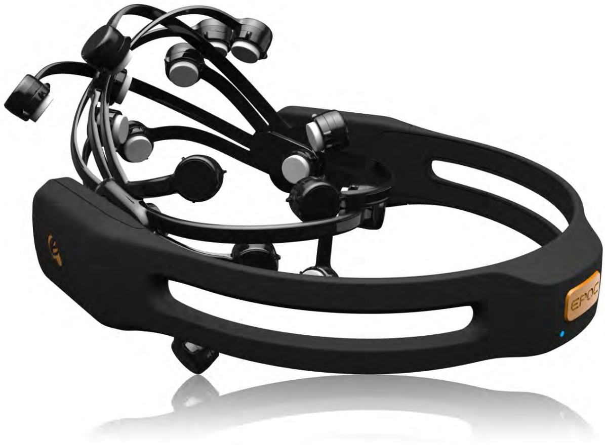
Рис. 1. Emotiv EPOC — устройство, используемое для записи данных ЭЭГ.
