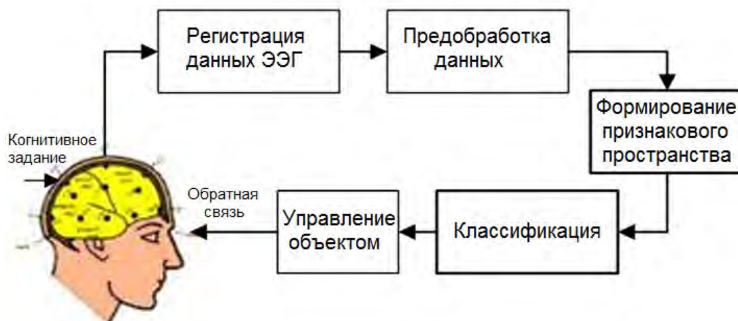
Рис. 5. Общая схема работы нейрокомпьютерных интерфейсов.
